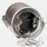
CATALISADOR DERRETIDO Sobreaquecimento
